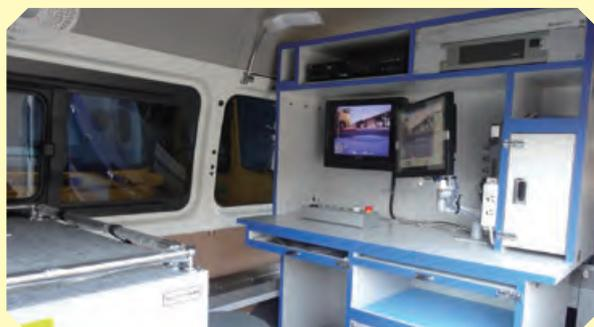
車両内部にてモニターで確認しながらカメラ車を操作します。
