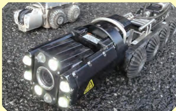
小規模用カメラ…φ150～200mm対応。小口径のマンホールも対応できます。
